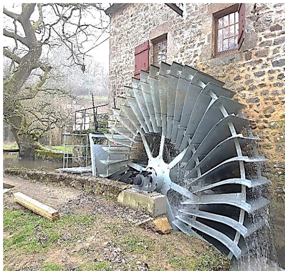
Modèle de roue à aubes retenu pour le projet du Moulin
